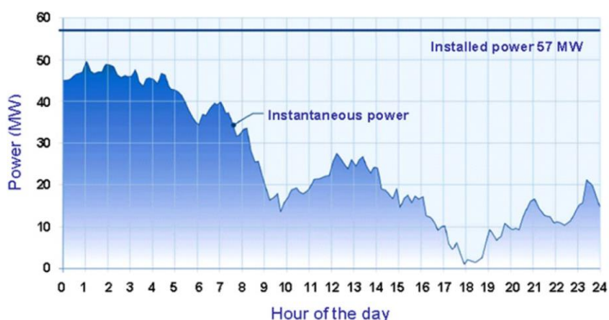
Fig. 2: Flutuação da potência instantânea em 16 de Março de 2004 em Cap-Chat (Quebec – Canada) em um parque eólico (com 76 turbinas) (IBRAHIM; ILINCA; PERRON, 2007)
